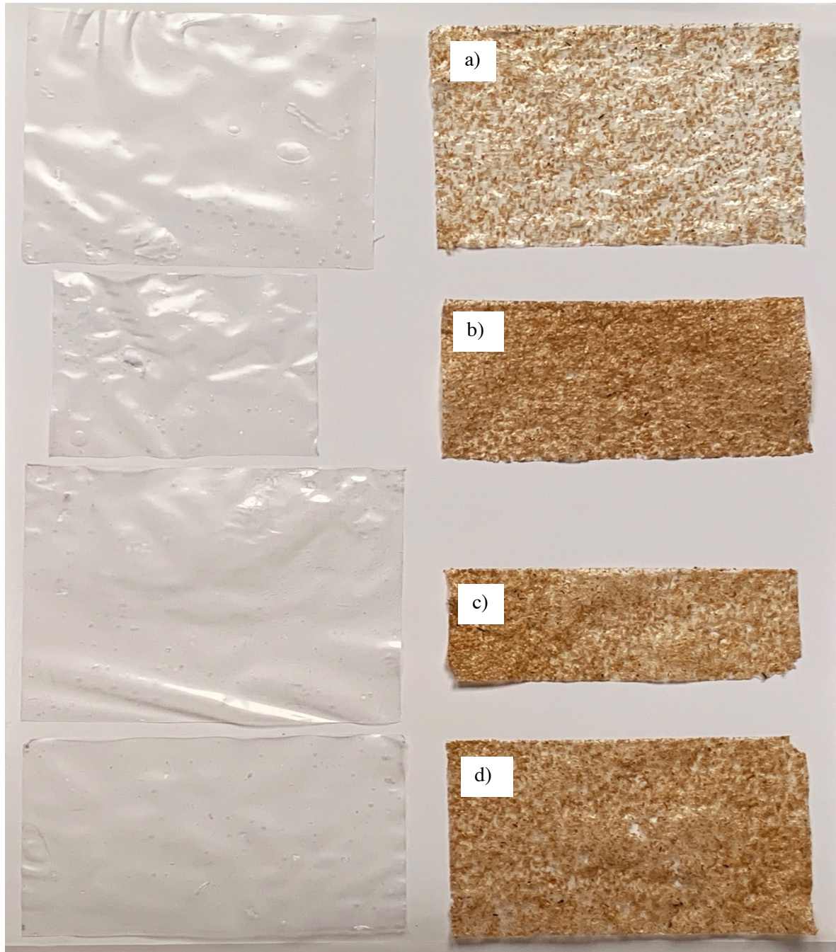
Abbildung 23: Acht der neun finalen Proben der zwei Folientypen. Die Folienprobe a) des ersten Durchgangs ist dünner als b), c) und d) des zweiten Durchgangs.
