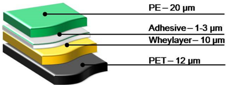
Abbildung 29: Eine mehrschichtige Folie aus PE, einem Whey-layer und PET. 139
