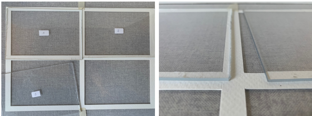
Abbildung 21: Aufbau zur Formgebung und Trocknung der Folien.
