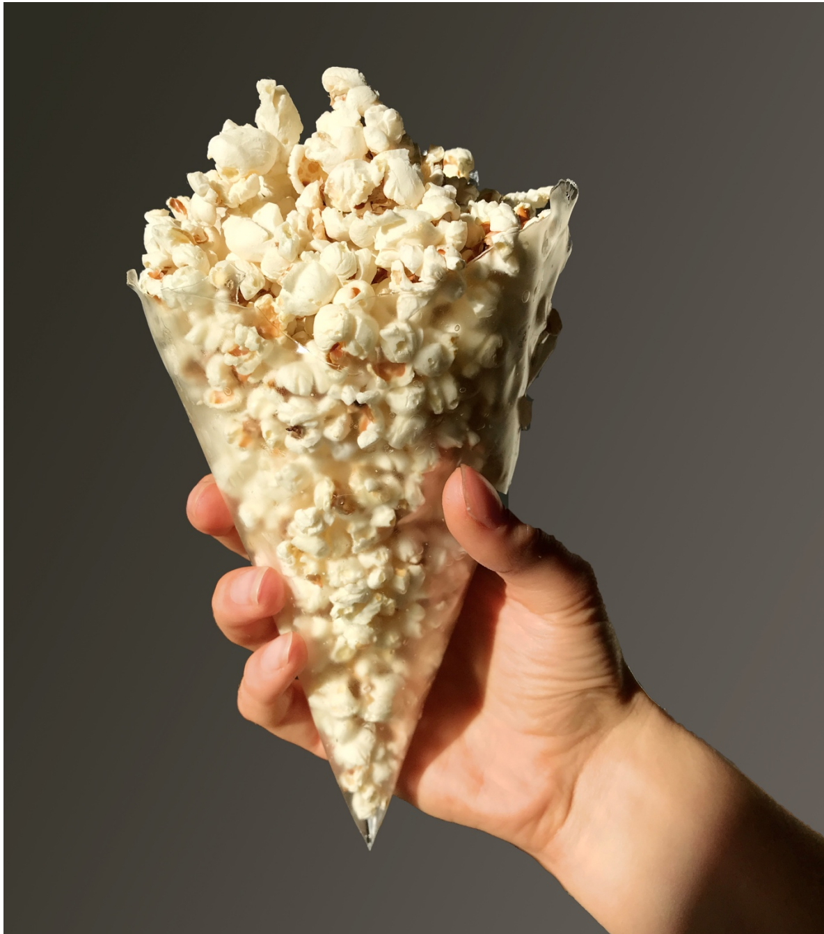
Abbildung 28: Mögliche Anwendung der untersuchten Biofolien. Weil die biologisch abbaubaren Folien hydrophil sind, quellen sie beim Kontakt mit Wasser. Sie könnten sich aber als Tüte für fettige Speisen eignen.
