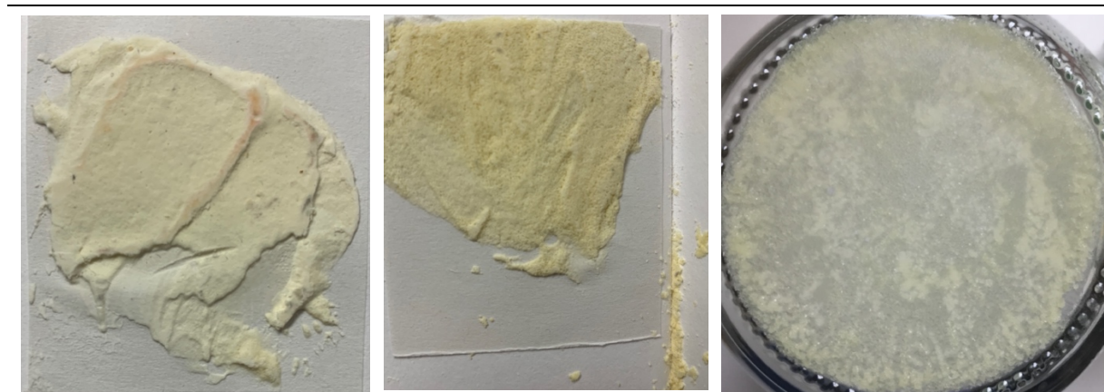
Abbildung 9: Vorversuche mit Molke wurden hart und zerbrechlich.
