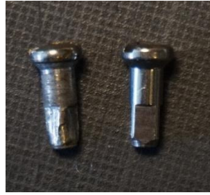
Abbildung 18: Kaputter Nippel (links) und neuer Nippel (rechts) (eigenes Foto)
