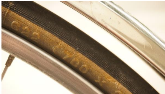
Abbildung 15: Spröder Vorderreifen (eigenes Foto)
