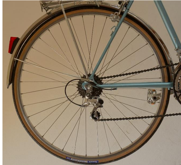
Abbildung 20: Hinterrad mit neuer Speiche und neuem Schlauch (eigenes Foto)
