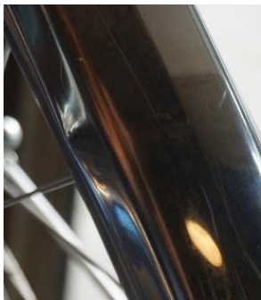
Abbildung 24: Vorderes Schutzblech mit Delle (eigens Foto)
