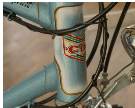
Abbildung 30: Neues Kabel für Rücklicht, sicher verlegt (eigenes Foto)
