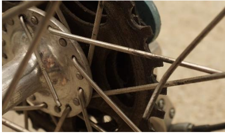
Abbildung 19: Zerbrochene Speiche im Hinterrad (eigenes Foto)
