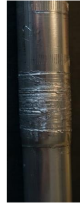
Abbildung 6: Beschädigte Stelle am Lenker (eigenes Foto)
