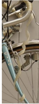
Abbildung 4: Gelöstes Lenkerband (eigenes Foto)
