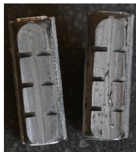
Abbildung 12: Alte Bremsklötze mit deutlichen Gebrauchsspuren (eigenes Foto)
