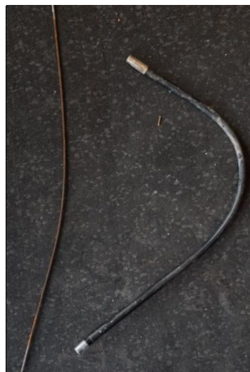
Abbildung 9: Rostiger Schaltzug und Aussenhülle (eigenes Foto)
