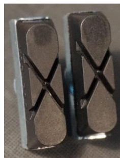
Abbildung 13: Neue Bremsklötze (eigenes Foto)
