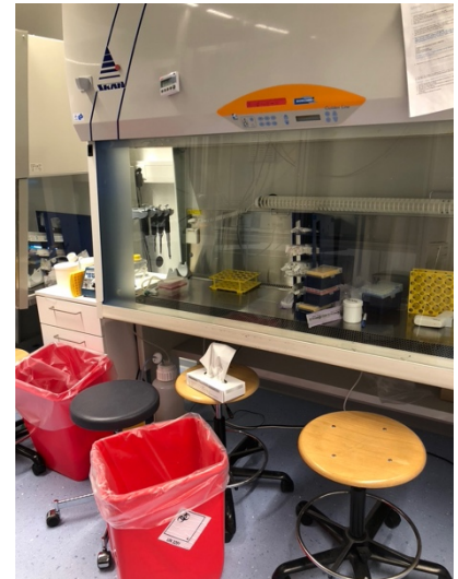
Abbildung 2: Zellkultur-Abzugshaube, um Kontamination zu vermeiden [16]
