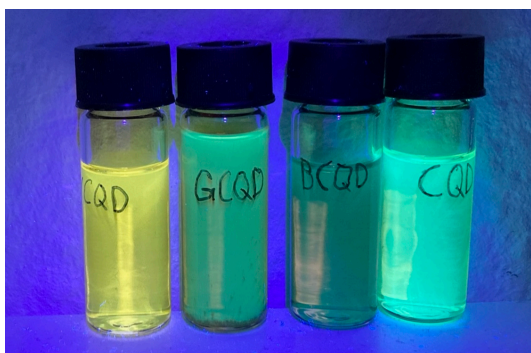
Abb. 16 Proben der Kohlenstoff-Quantenpunkte unter UV-Licht, links nach rechts: YCQD, GCQD, BCQD, CQD ungereinigt
