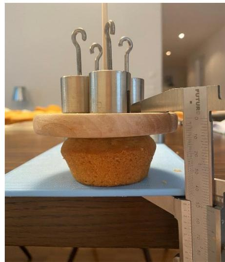
Abbildung 9: Test zur Kompressibilität: Mit der Schiebelehre wird die Höhe gemessen, von der danach die Dicke der Scheibe und des Brettes abgezogen werden, so dass man die Höhe des eingesunkenen Muffins erhält.
