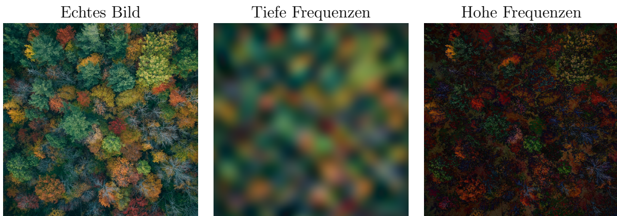
Abbildung 27: Fourier Bilder mit unterschiedlichen Frequenzbereichen. In der Mitte wurden tiefe (0 – 8-fache Frequenz der Grundschwingung) und rechts hohe Frequenzen (2 – 256-fache Frequenz der Grundschwingung) zurücktransformiert.
