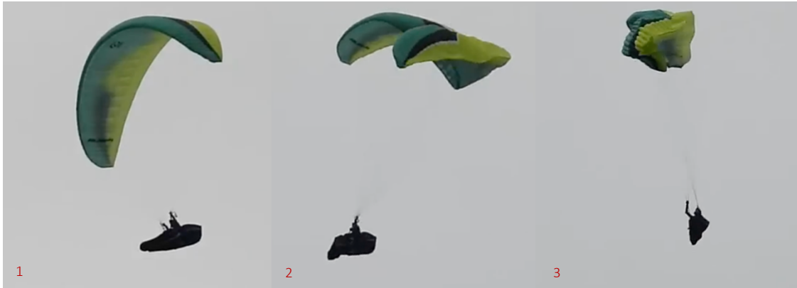
Abb. 75: Einleitung des symmetrischen Frontklappers (Nicolas Huber)
