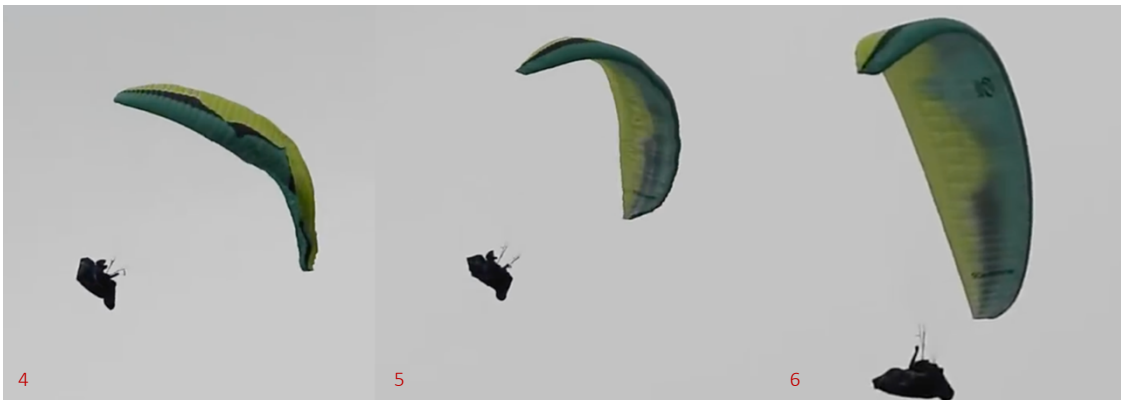
Abb. 76: Ausleitung des symmetrischen Frontklappers (Nicolas Huber)
