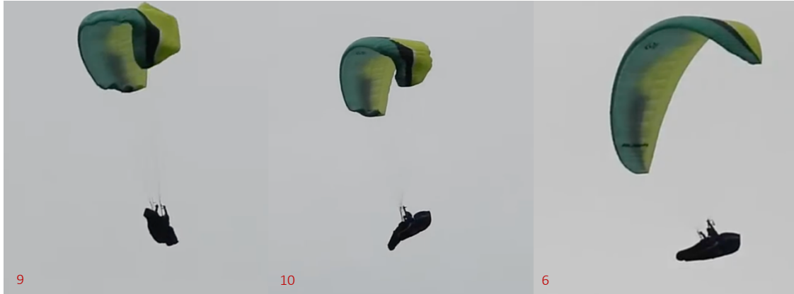
Abb. 78: Ausleitung des asymmetrischen Klappers (Nicolas Huber)
