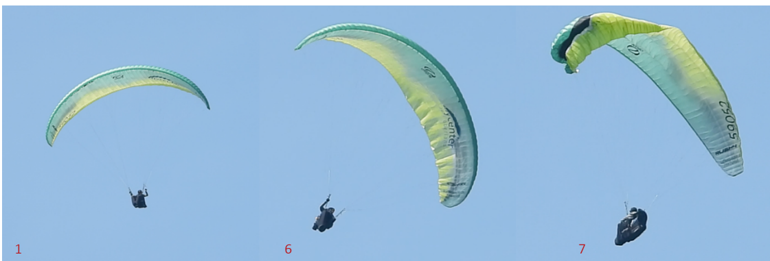
Abb. 72: Einleitung des asymmetrischen Strömungsabrisses (Nicolas Huber)
