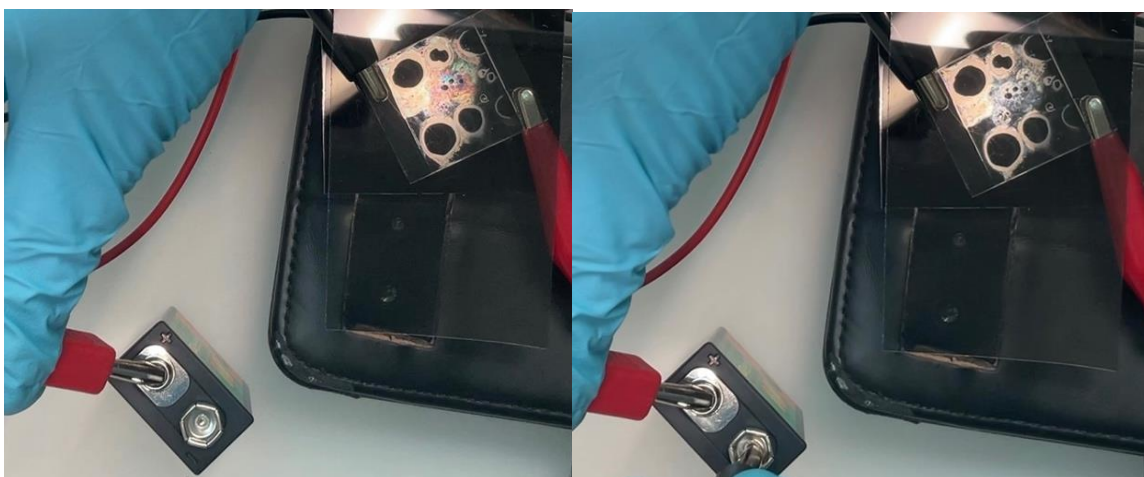
Abbildung 39: Links sind die Moleküle nicht ausgerichtet, rechts sind die Moleküle ausgerichtet (eigenes Foto, 2023)
