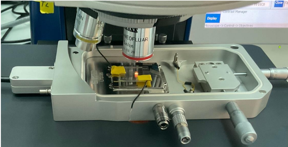
Abbildung 35: LCD-Zelle auf Heizplatte (ETH-Labor) (eigenes Foto, 2023)
