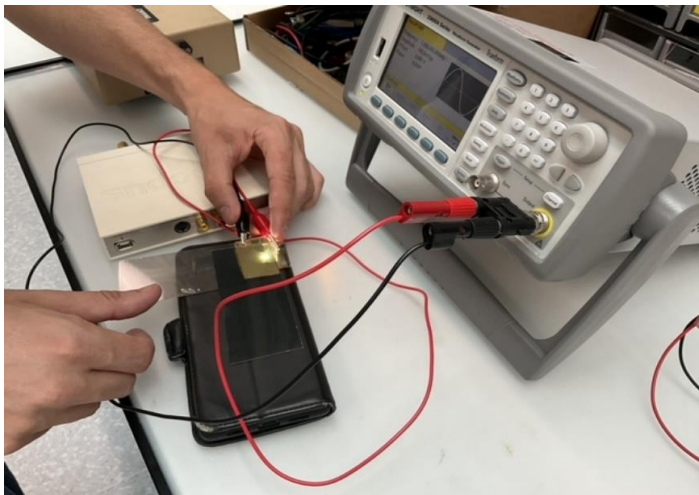
Abbildung 52: LCD-Zelle angeschlossen am Wellengenerator
