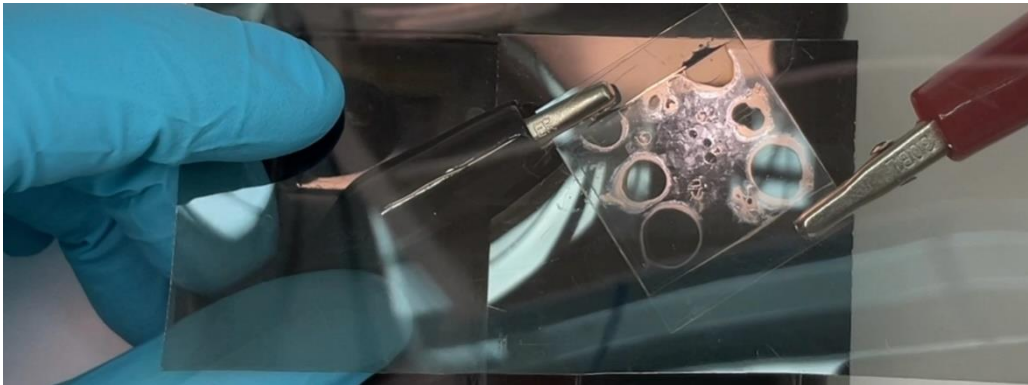
Abbildung 36: Moleküle der Flüssigkristallschicht richten sich aus aufgrund des erzeugten elektrischen Feldes (eigenes Foto, 2023)
