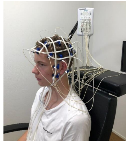
Abbildung 19. Fertig eingerichtete EEG-Haube mit 21 ableitenden Elektroden.
