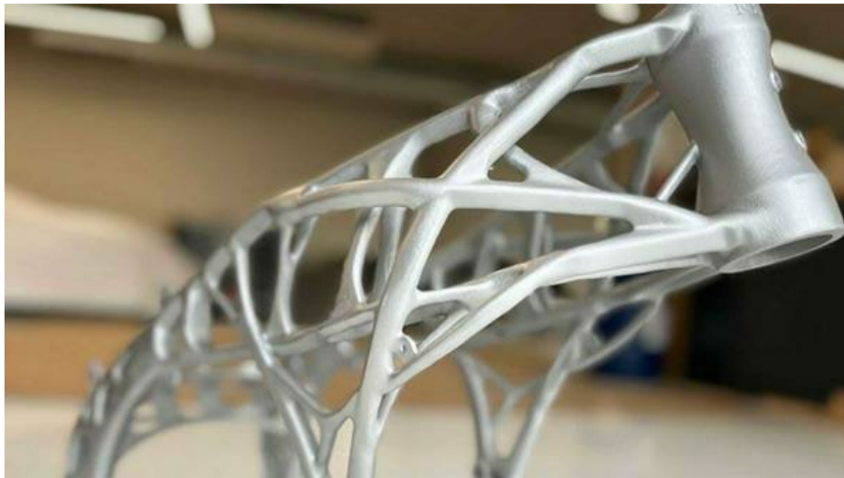
Abbildung 2-4: Gewichtersparnisse durch optimierte Formen aus dem SLS 3D-Drucker [54]
