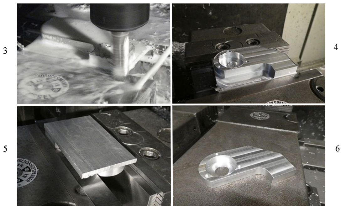
Abbildung 6-13: Herstellung eines Teils des Dosierungssystems
