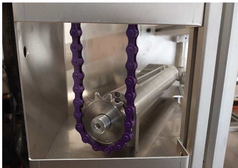
Abbildung 5-18: Kette für den Antrieb des Dosierungssystems
