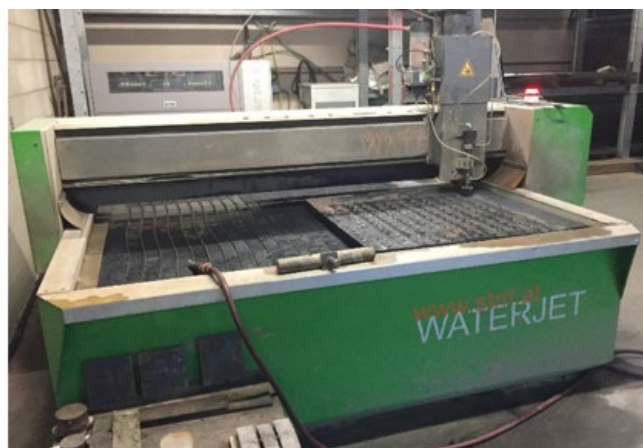
Abbildung 6-6: Funktionsweise eines Wasserstrahlschneiders [55] und verwendeter Wasserstrahlschneider
