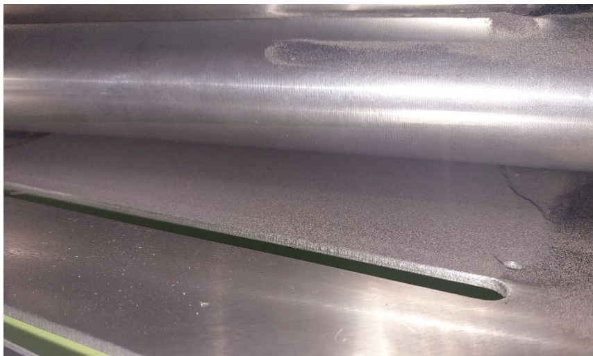
Abbildung 5-20: Schlitz, in welchen das überschüssige Pulver fällt
