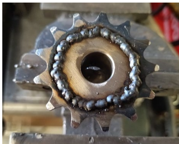
Abbildung 6-10: MIG-geschweisstes Teil des Dosierungssystems
