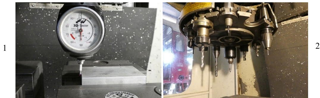
Abbildung 6-12: Nullpunkt bestimmen und Werkzeugwechsler
