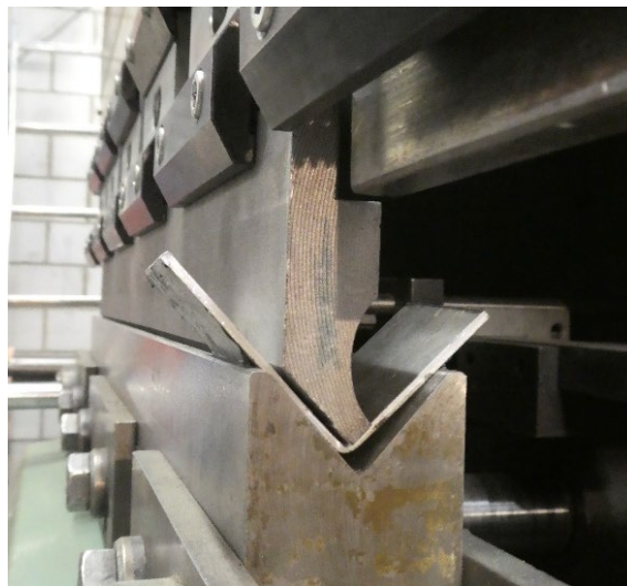
Abbildung 6-7: Matrize und Stempel einer Abkantpresse
