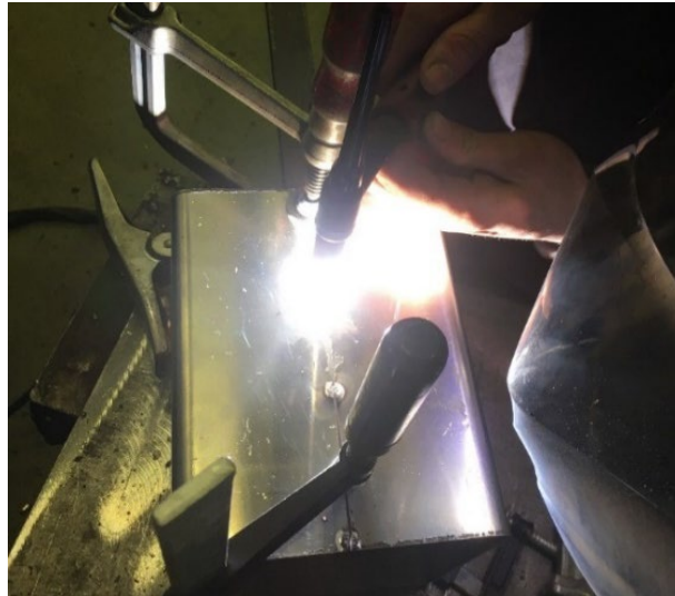
Abbildung 6-11: WIG-Schweissen des Druckraums
