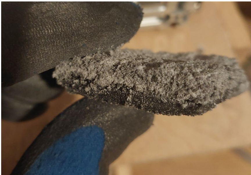
Abbildung 4-2: Erfolgreich gedrucktes Puderzucker-Objekt (PZ8)
