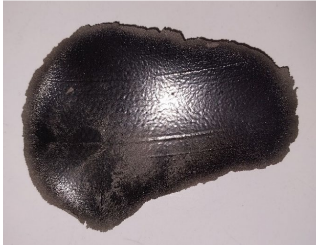
Abbildung 7-8: Verbrannte Oberfläche bei 160^{\circ}\text{C}
