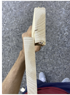
Abbildung 7.2: Bruch eines Elements
