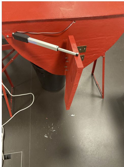
Abbildung 7.3: Fertiger Einbau des Ruders
