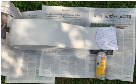
Abbildung 12: Versiegelung der Gipsoberfläche mit Uni-versallack
