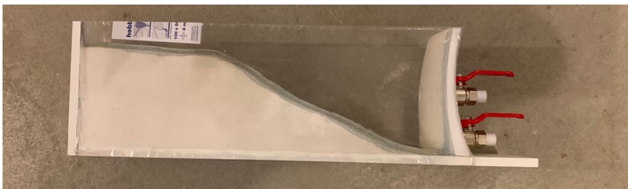
Abbildung 14: Seitenansicht des Modells mit Auslassventilen
