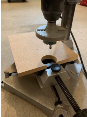
Abbildung 11: Bohrung für das Einlassrohr
