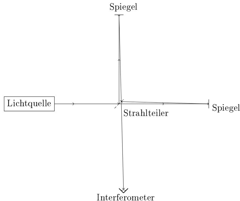
**Abbildung 2.1:** *Aufbau des Michelson-Morley-Experiments. Das Licht tritt aus der Lichtquelle heraus, teilt sich am Strahlteiler und wird von den Spiegeln reflektiert. Danach wird es vom Strahlteiler wieder vereinigt und in den Interferometer geleitet. Für visuelle Klarheit werden hier die Unterschiede zwischen den Lichtbahnen desselben Spiegels hervorgehoben – im Experiment laufen die Lichtstrahlen entlang des genau gleichen Pfades.*
