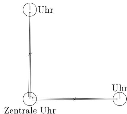
**Abbildung 2.4:** Aufbau des Michelson-Morley-Experiments aus der Sicht des mitbewegenden Betrachters,  $M'$ . Die zentrale Uhr sendet zum Zeitpunkt  $t = 0$  ein Lichtpuls zu den beiden Uhren aus, die das Licht gespiegelt zurückwerfen und ihre Zeiten synchronisieren.
