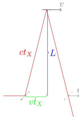
**Abbildung 2.3:** Lotrechte Lichtbahn in einem bewegten Michelson-Morley-Experiment aus der Sicht des Äthers. Der Lichtstrahl tritt beim Strahlteiler aus, trifft nach  $t_X$  den Spiegel, welcher eine Entfernung  $L$  zum Strahlteiler besitzt und dann wiederum, nach  $2t_X$ , den Strahlteiler. Während dieser Zeit bewegt sich das Gerät mit einer Geschwindigkeit  $v$ .
