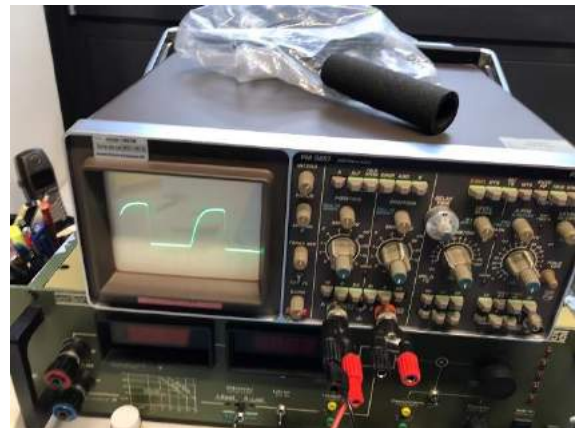
Abbildung 13: Fotografie des Oszilloskops, während es am Empfangenden LVS hängt. (eigene Aufnahme 2019)
