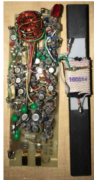
Abbildung 9: Platine und Ferritstabantenne eines Autophon VS-68 LVS (eigene Aufnahme 2019)
