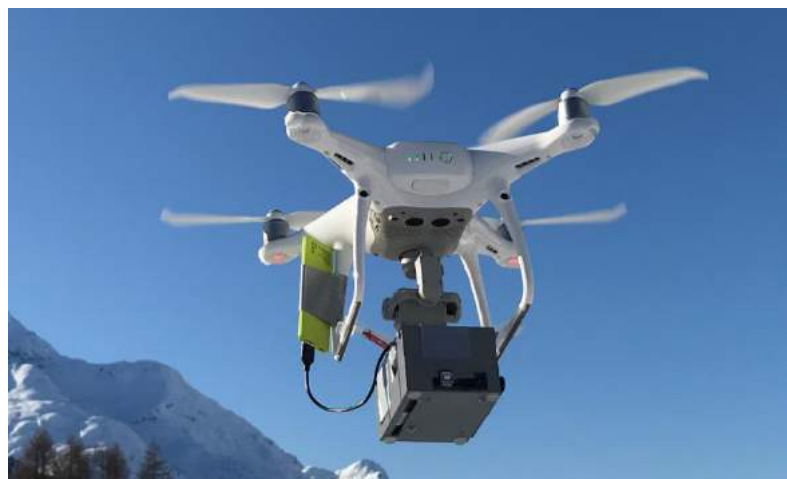
Abbildung 19: Hier sieht man, wie ich die Batterie beim finalem Produkt an der Drohne zu befestigen, damit sie so weit weg wie möglich von der LVS-Antenne ist. (Grüne Box, links an der Drohne) (eigene Aufnahme 2019)
